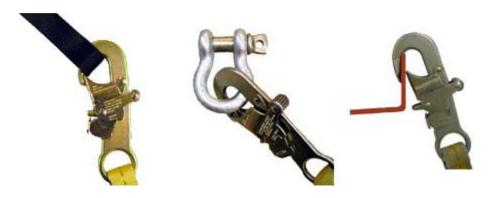
Le règlement CSA Z259.12.01 (www.csa.ca) exige une très faible résistance à la torsion sur l'ouverture d'un connecteur (+/- 250 lbs). De plus, de nombreux tests ont démontré que si une force équivalant à une chute typique est appliquée sur l'ouverture d'un connecteur, celui-ci va plier et s'ouvrir et le travailleur peu tomber en chute libre.
