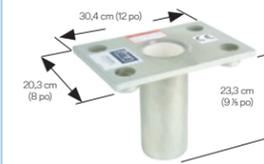
Construction en acier doux. Les logements de fixation encastrés permettent une installation par boulonnage dans une structure existante en béton ou en acier. La conception de montage encastré permet le passage de la circulation et élimine les risques de trébuchement lorsque le manchon n'est pas en usage. Doté d'une doublure en PVC.
