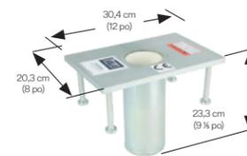
Construction en acier doux. Doté de goupilles pour le béton frais et d'ancrages pour le béton à couler en place pour les nouvelles constructions ou les rénovations. La conception de montage encastré permet le passage de la circulation et élimine les risques de trébuchement lorsque le manchon n'est pas utilisé. Doté d'une doublure en PVC.
