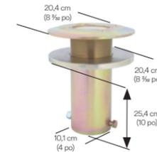
Conçu pour être installé en se faisant glisser dans un trou de 10,1 cm (4 po) dans un plancher existant. La conception de montage encastré permet le passage de la circulation et élimine les risques de trébuchement lorsque le manchon n'est pas utilisé. Offert avec une doublure en PVC, une butée en plastique et les accessoires de montage. Il se fixe sur des surfaces d'une épaisseur de 6,4 mm à 50,8 mm (1/4 po à 2 po).
