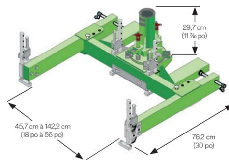
Doté d'un ensemble de manchon réglable (8511232). Utilisé sur les passages dotés d'une structure à bride sur laquelle on peut fixer l'unité. Il est possible de fixer ce collier sur une bride d'une épaisseur maximale de 15,2 cm (6 po). Poids : 37,2 kg (82 lb)
