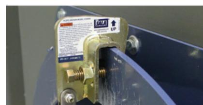
Conçu pour être fixé à une bride verticale ou horizontale allant jusqu'à 15,2 cm (6 po) d'épaisseur et pour créer un point d'ancrage pour le raccordement d'un palan de poteau.
